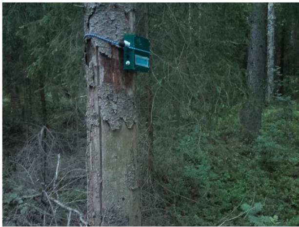
Kuva 21. Passiivilepakkodetektorit laitettiin erilaisiin biotooppeihin tallentamaan lepakoiden päästämiä ultraääniä.
