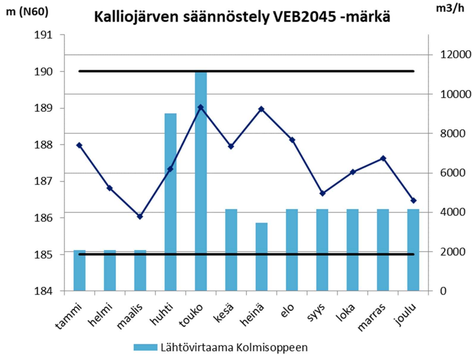
Kuva 4-28. Kerran 100 vuodessa toistuvan määrän vuoden Kalliojärven säännöstely YVA vaihtoehdolla 2B vuonna 2045.
