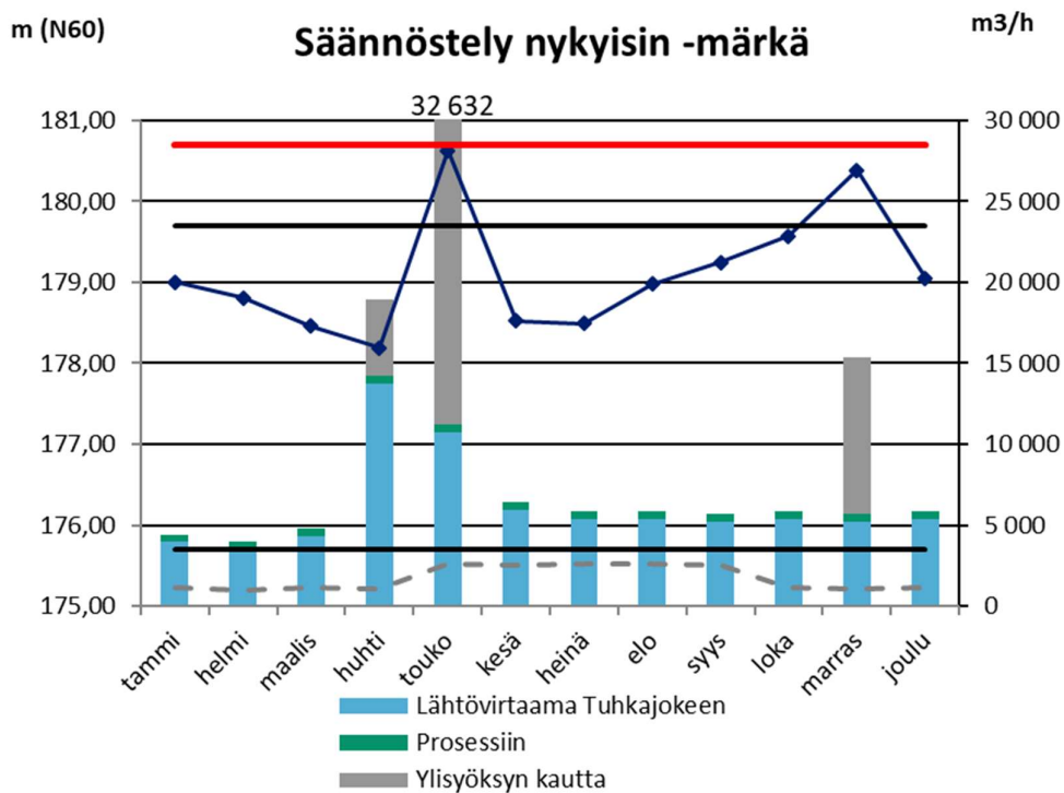
Kuva 4-2. Säännöstely nykyisin kerran 100 vuodessa toistuvassa määrässä tilanteessa, katkoviivalla kuvattu Tuhkajokeen juoksutettava minimivirtaama
