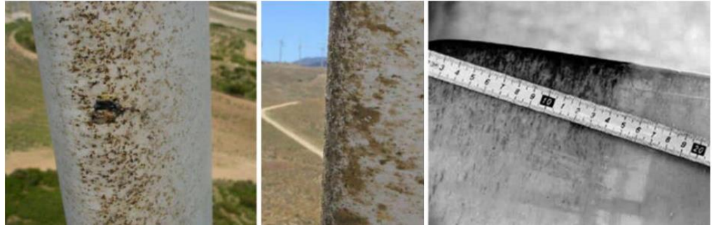
Hyönteisten jäännöksiä turbiinin siivessä. Lähde: Trieb, "Interference of Flying Insects and Wind Parks", 2008.
