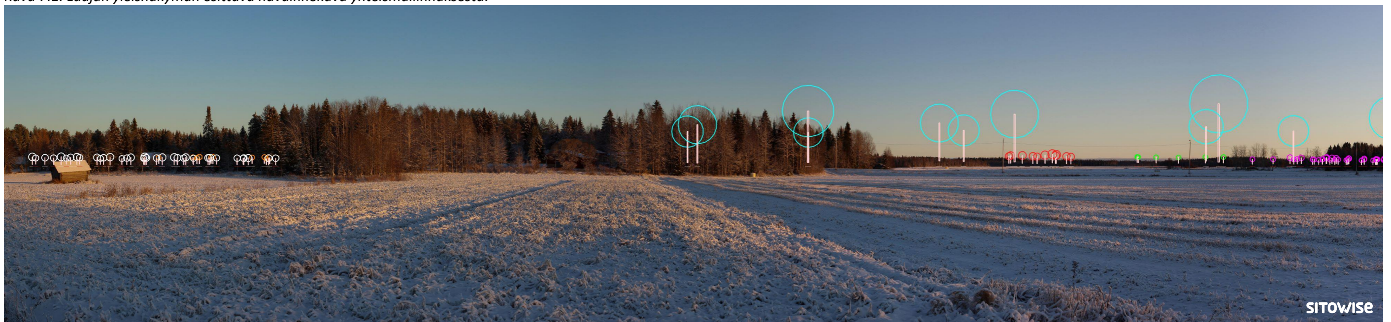
Kuva 7.2. Mallinnus tuulivoimaloiden sijainnista valokuvan päälle. Kuvassa on korostettu voimaloiden tornit valkoisilla viivoilla ja laipojen pyörimisaluet ympyröillä alla olevan selitteen mukaisilla väreillä.
