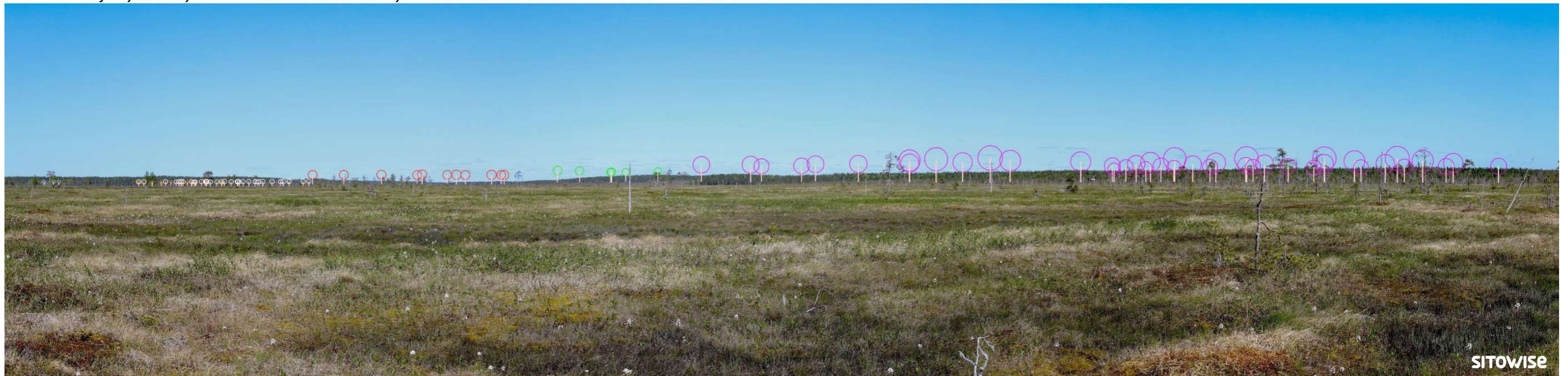
Kuva 8.2. Mallinnus tuulivoimaloiden sijainnista valokuvan päälle. Kuvassa on korostettu voimaloiden tornit valkoisilla viivoilla ja laajojen pyörimisalueet ympyröillä alla olevan selitteen mukaisilla väreillä.
