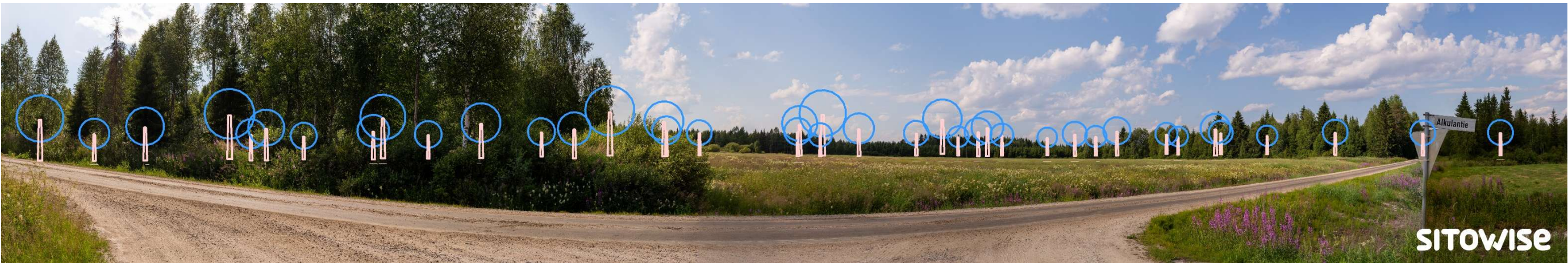
Kuva 2-23 Mallinnus tuulivoimaloiden sijainneista valokuvan päällä. Lapojen pyörähdysliikkeen alue korostettuna.
