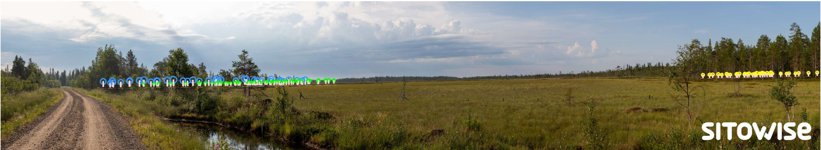
Kuva 2-137 Mallinnus tuulivoimaloiden sijainneista valokuvan päällä. Lapojen pyörähdysliikkeen alue korostettuna.
