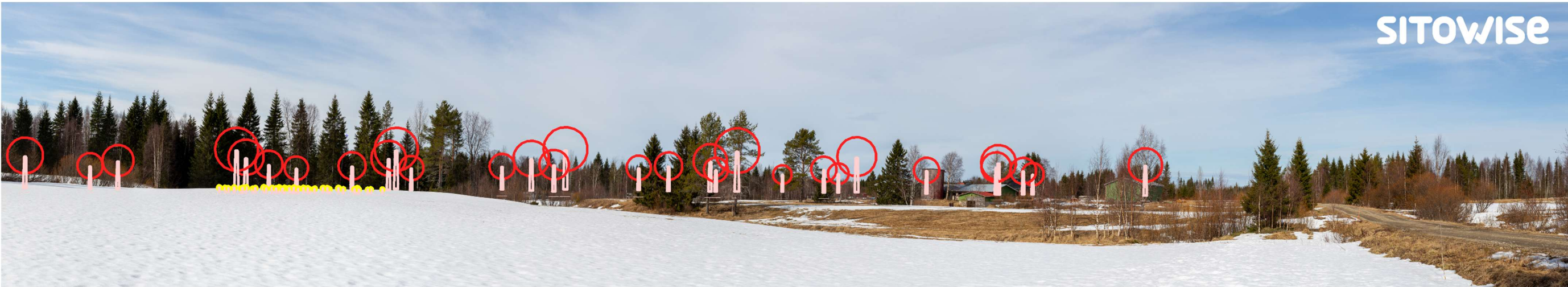
Kuva 2-50 Mallinnus tuulivoimaloiden sijainneista valokuvan päällä. Lapojen pyörähdysliikkeen alue korostettuna.
