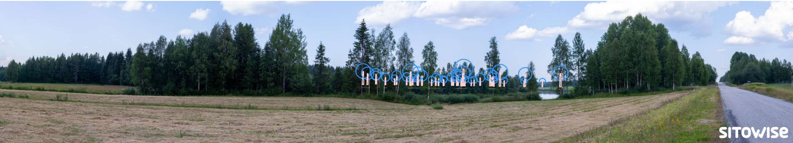
Kuva 2-87 Mallinnus tuulivoimaloiden sijainneista valokuvan päällä. Lapojen pyörähdysliikkeen alue korostettuna.
