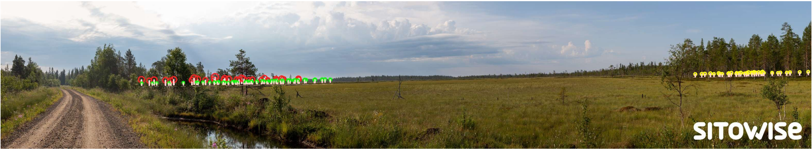
Kuva 2-140 Mallinnus tuulivoimaloiden sijainneista valokuvan päällä. Lapojen pyörähdysliikkeen alue korostettuna.
