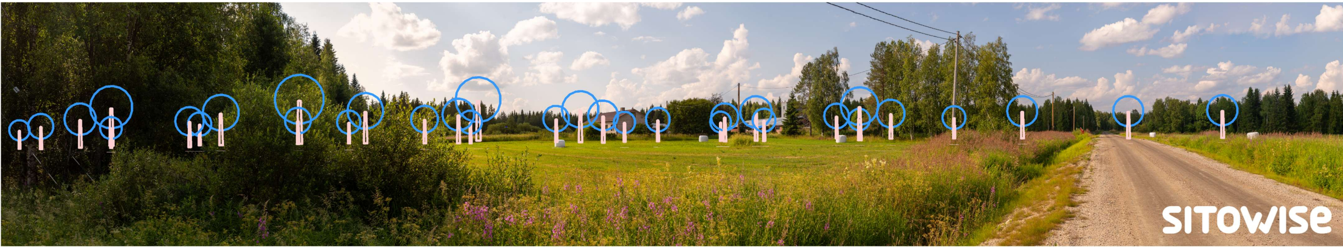
Kuva 2-11 Mallinnus tuulivoimaloiden sijainneista valokuvan päällä. Lapojen pyörähdysliikkeen alue korostettuna.
