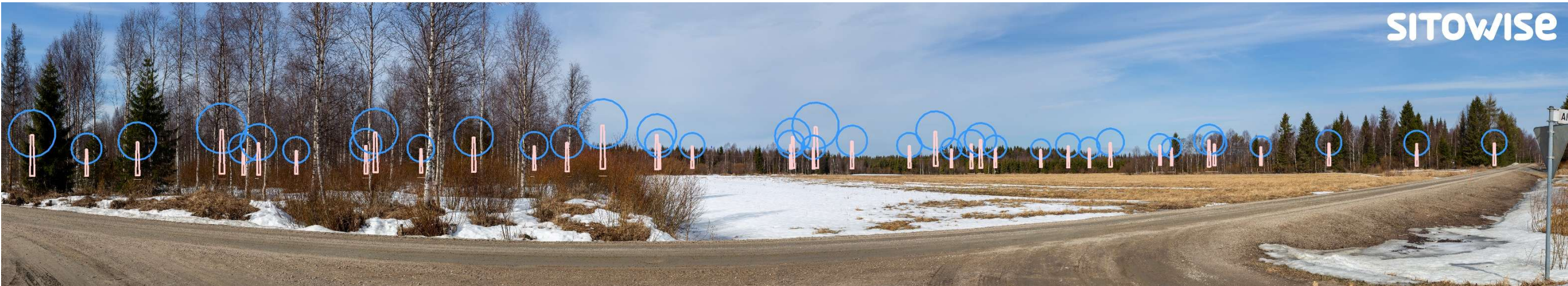
Kuva 2-19 Mallinnus tuulivoimaloiden sijainneista valokuvan päällä. Lapojen pyörähdysliikkeen alue korostettuna.
