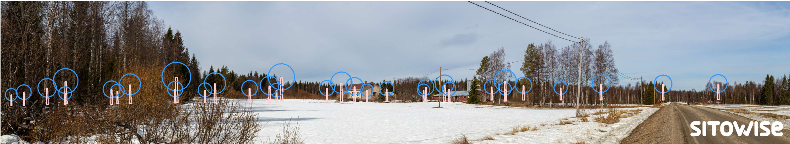
Kuva 2-7 Mallinnus tuulivoimaloiden sijainneista valokuvan päällä. Lapojen pyörähdysliikkeen alue korostettuna.
