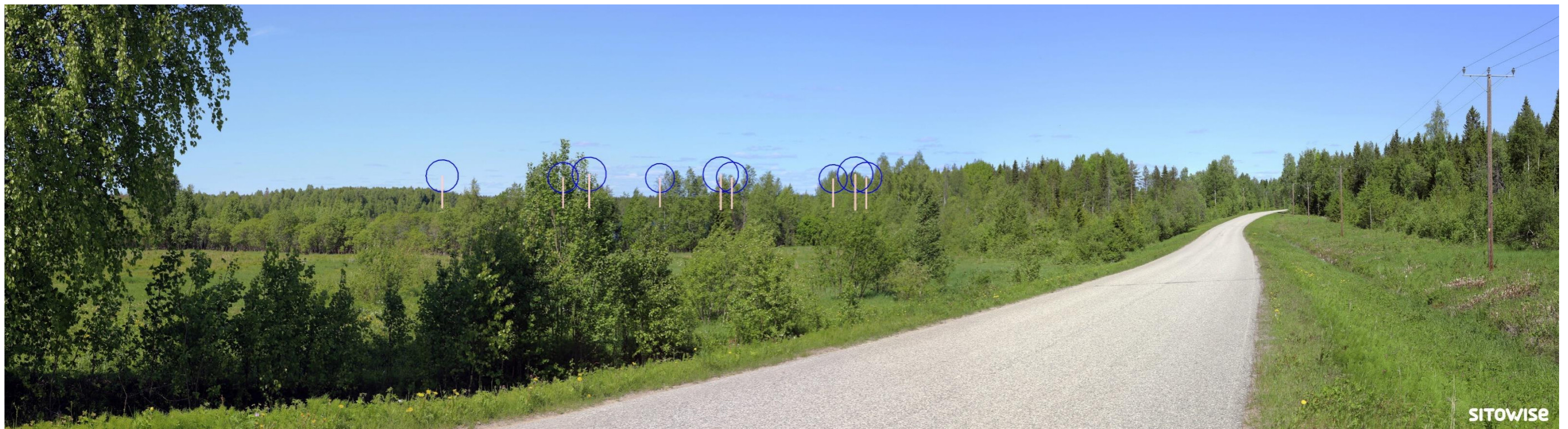
Kuva 11.8. Mallinnus tuulivoimaloiden sijainnista valokuvan päälle. Kuvassa on korostettu voimaloiden tornit valkoisilla viivoilla ja lapojen pyörimisaluet sinisillä ympyröillä.
