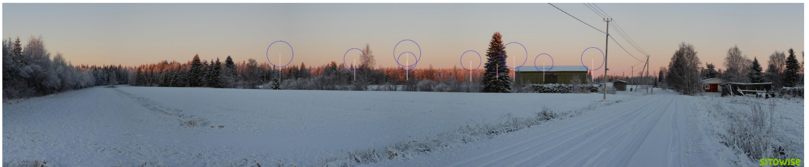
Kuva 1.6. Mallinnus tuulivoimaloiden sijainnista valokuvan päälle. Kuvassa on korostettu voimaloiden tornit valkoisilla viivoilla ja lapojen pyörimisaluet sinisillä ympyröillä.
