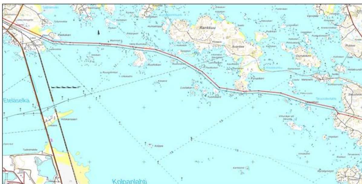
Kuva 1-3 Linjausvaihtoehdon VE2 mukaiset voimajohdon (punainen viiva) ja voimajohtopylväiden alustavat sijainnit (mustat pisteet) Kolpanlahden alueella.
