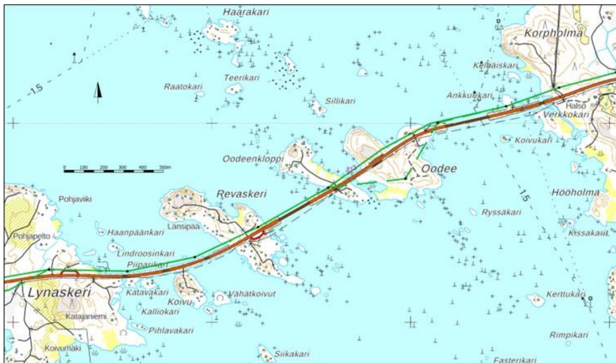
Kuva 1-2 Linjausvaihtoehdon VE1 mukaisten voimajohdon (vihreä viiva) ja voimajohtopylväiden alustavat sijainnit (mustat pisteet) Pohjaselän alueella. Vihreä katkoviiva kuvaa vaihtoehtoisia paikallisia linjauksia. Linjaus tarkentuu jatkosuunnittelun yhteydessä.
