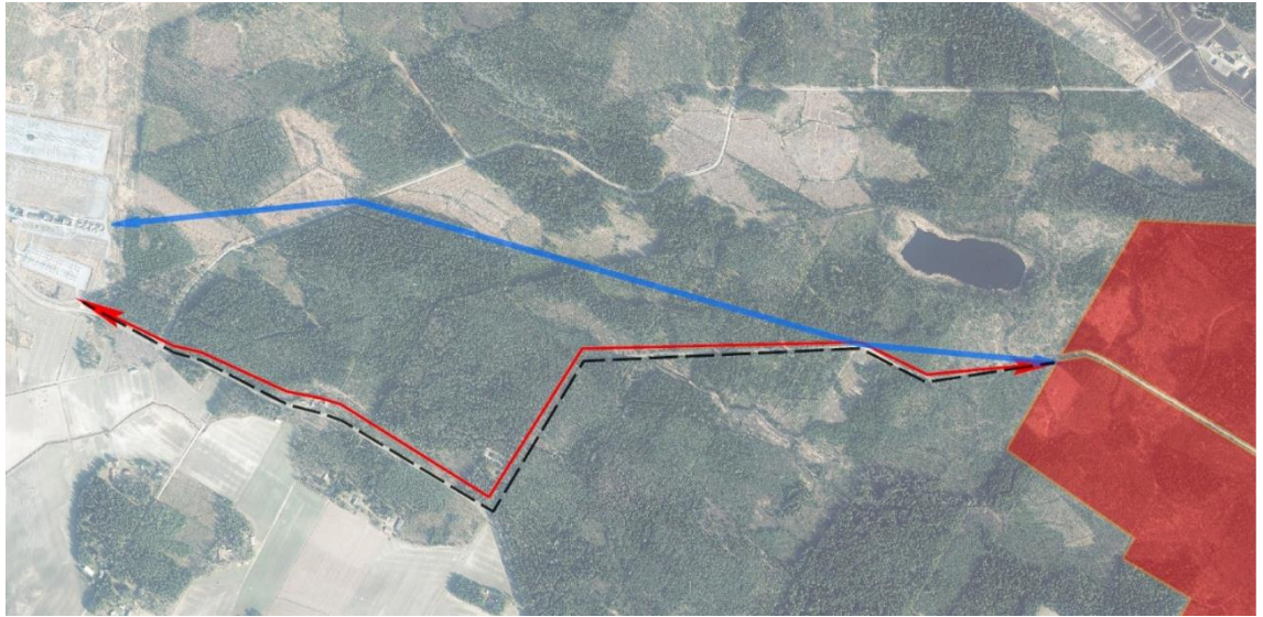
Kuva 34. Ilmajohtovaihtoehto esitettynä sinisellä nuolella Ilmakuvapohjalla (punainen katkoviiva kuvaa maakaapelilinjaa). Hankealuetta punaisella vinoviivituksella kuvan oikeassa reunassa. Sähköasemarakennukset ja sähköasemaympäristö erottuvat ilmakuvassa vaaleansävyisinä rakennuksina ja vaaleana kenttänä.
