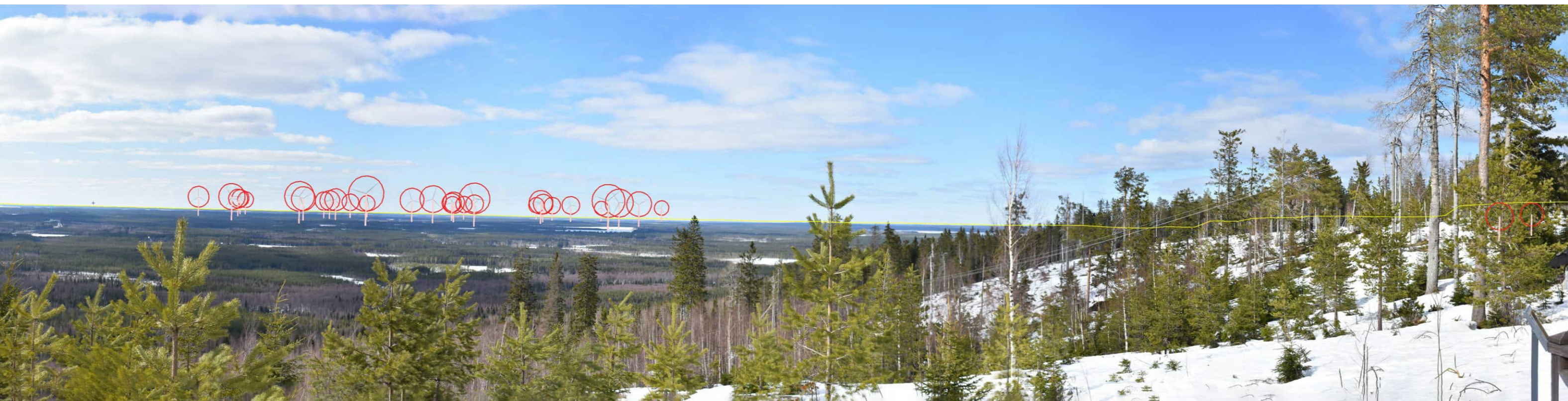
Kuva 20. Kuvauspiste 7, Havainnekuvaluonnos Kivesvaaran näköalatasanteelta.. Etäisyys lähimpään tuulivoimalaitokseen 5,4 km. Tuulivoimaloiden roottoriympyrät korostettuna punaisella.
