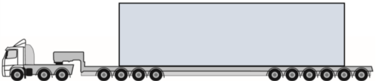
Kuva 2: Esimerkkikuva lastatusta tornilohkon erikoiskuljetuksesta (Tuulivoimarakentaminen tienpitäjän näkökulmasta)
