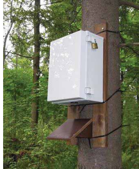
Kuva 1 ja 2. AnaBat –laite sekä akku sijoitettiin säänkestävään ja lukittavaan sähkökaappiin, joka kiinnitettiin puuhun. Detektorin mikrofoni osoittaa alaspäin, lepakko- sekä muut äänet heijastuvat kaltevan levyn kautta mikrofoniin. Kuvat eivät ole Mielmukkavaaralta, laitteet olivat kuitenkin samanlaiset kuten kuvassa.
