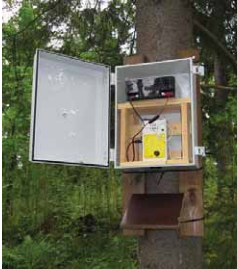
Kuva 1 ja 2. AnaBat –laite sekä akku sijoitettiin säänkestävään ja lukittavaan sähkökaappiin, joka kiinnitettiin puuhun. Detektorin mikrofoni osoittaa alaspäin, lepakko- sekä muut äänet heijastuvat kaltevan levyn kautta mikrofoniin. Kuvat eivät ole Mielmukkavaaralta, laitteet olivat kuitenkin samanlaiset kuten kuvassa.
