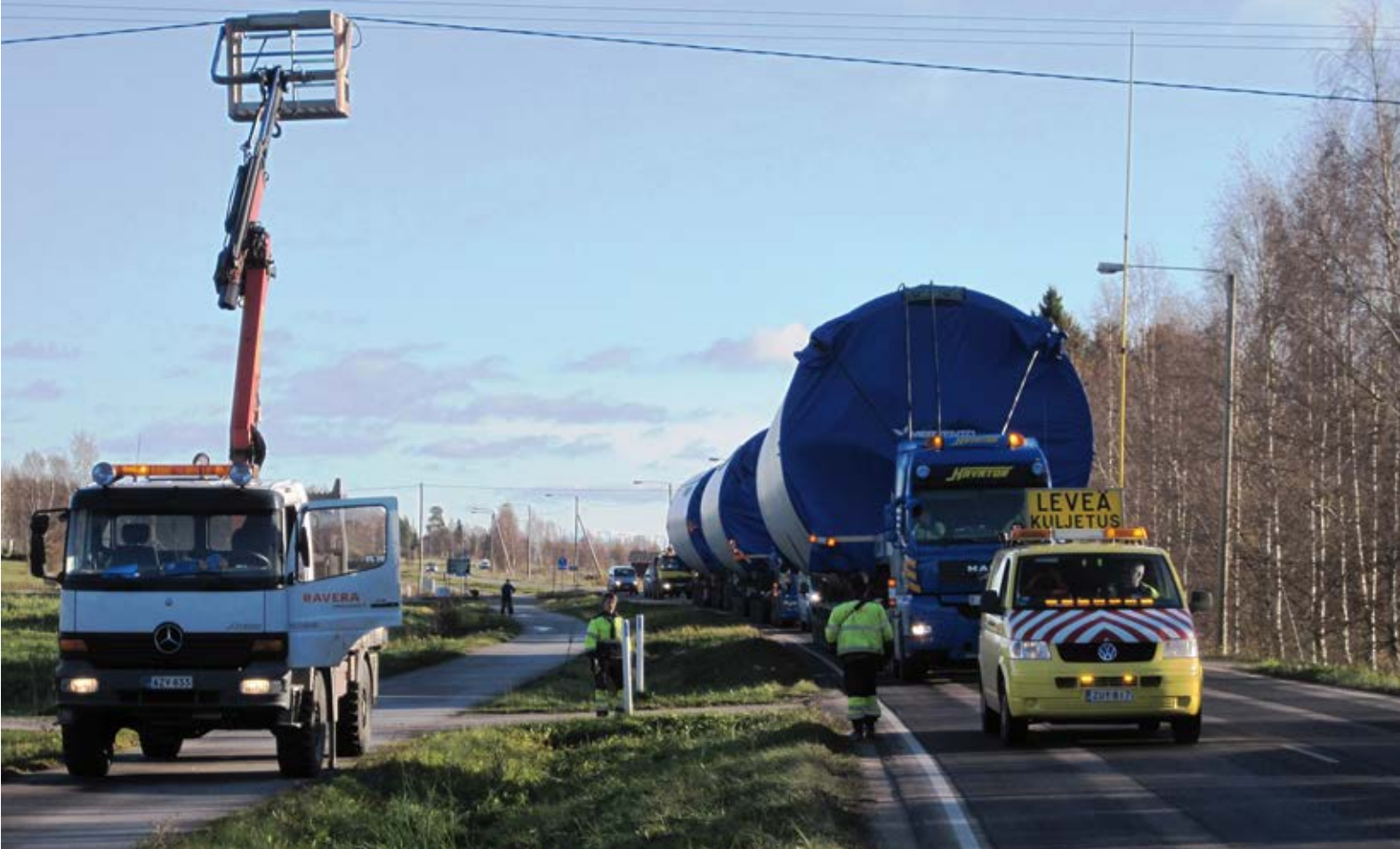
Kuva 19-4. Tornin osien erikoiskuljetus (Kuva: Etelä-Pohjanmaan ELY-keskus).
