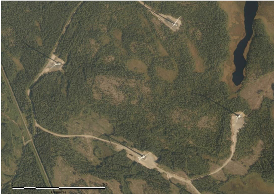
Bild 4.1. På flygbilden syns vindkraftverk som är i drift. Servicevägar och lyftfält har byggts för vindkraftverken. I omgivningen av vindkraftverken och mellan dem har den tidigare markanvändningen bevarats oförändrad (Lantmäteriverket). Bilden är inte från Lasorområdet.
