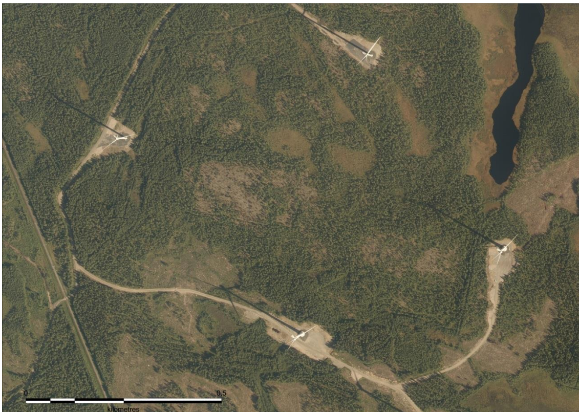
Bild 10. Av flygfotot framgår verksamma vindkraftverk. För vindkraftverken har byggts servicevägar och fält för lyftning. I vindkraftsområdets omgivning och i mellanområdena har den tidigare markanvändningen bestått oförändrad.
