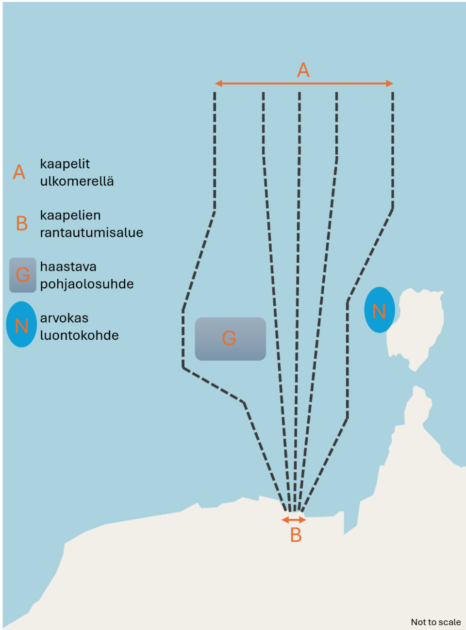
Kuva 2-8. Periaatekuva merikaapelien sijoittamisesta merellä pohjaolosuhteet ja arvokkaat luontokohteet huomioiden. Ulkomerellä ja syvemmissä olosuhteissa kaapelit ovat etäämpänä toisistaan ja tultaessa lähemmäs rantaa niiden välinen etäisyys pienenee. Tarkemmassa reittisuunnittelussa hankkeen jatkokehityksessä huomioidaan sekä haastavat pohjaolosuhteet, arvokkaat luontokohteet sekä muut mahdolliset rajoitteet kuten esimerkiksi laivaväylät.
