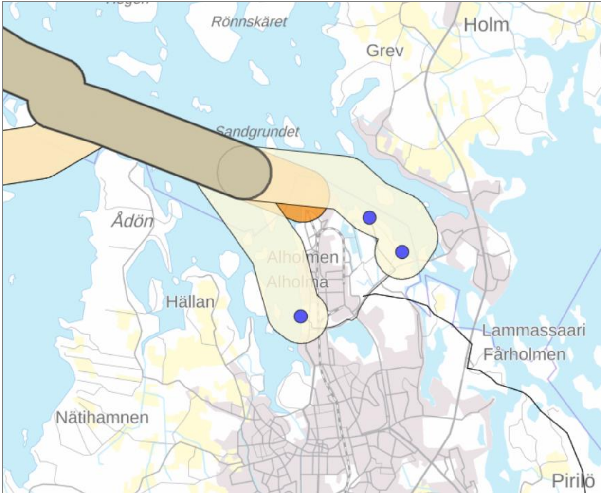
Kuva 2-10. Merikaapeli- ja vetyputkireittejä MVE4/VVE2 ja MVE5/VVE3 koskevat muutokset, jotka tehty suunnittelussa YVA-ohjelman jälkeen. Oranssi väri kuvastaa aiempaa suunnittelutilannetta.
