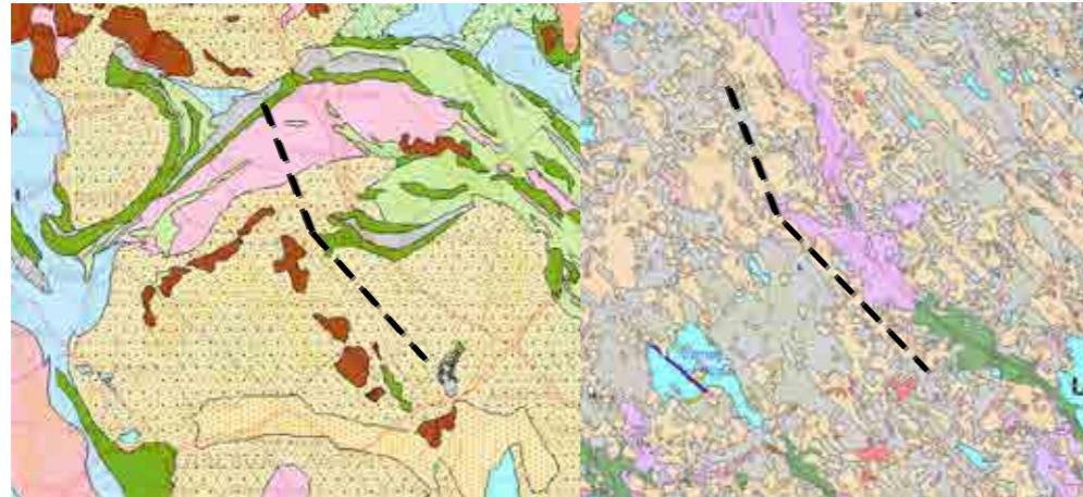
Kuva 9. Sähkönsiirtoreitin kallioperäolosuhteet (vasemmalla) ja maaperäolosuhteet (oikealla). Mustalla katkoviivalla osoitettu voimajohdon likimääräinen sijainti (GTK 2014).
