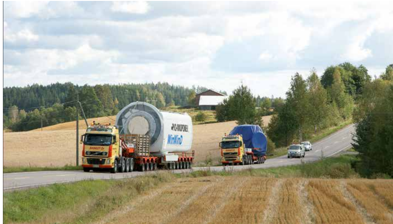
Kuva 113. Tuulivoimalan konehuoneen ja navan erikoiskuljetukset (Ville Silvasti Oy).
