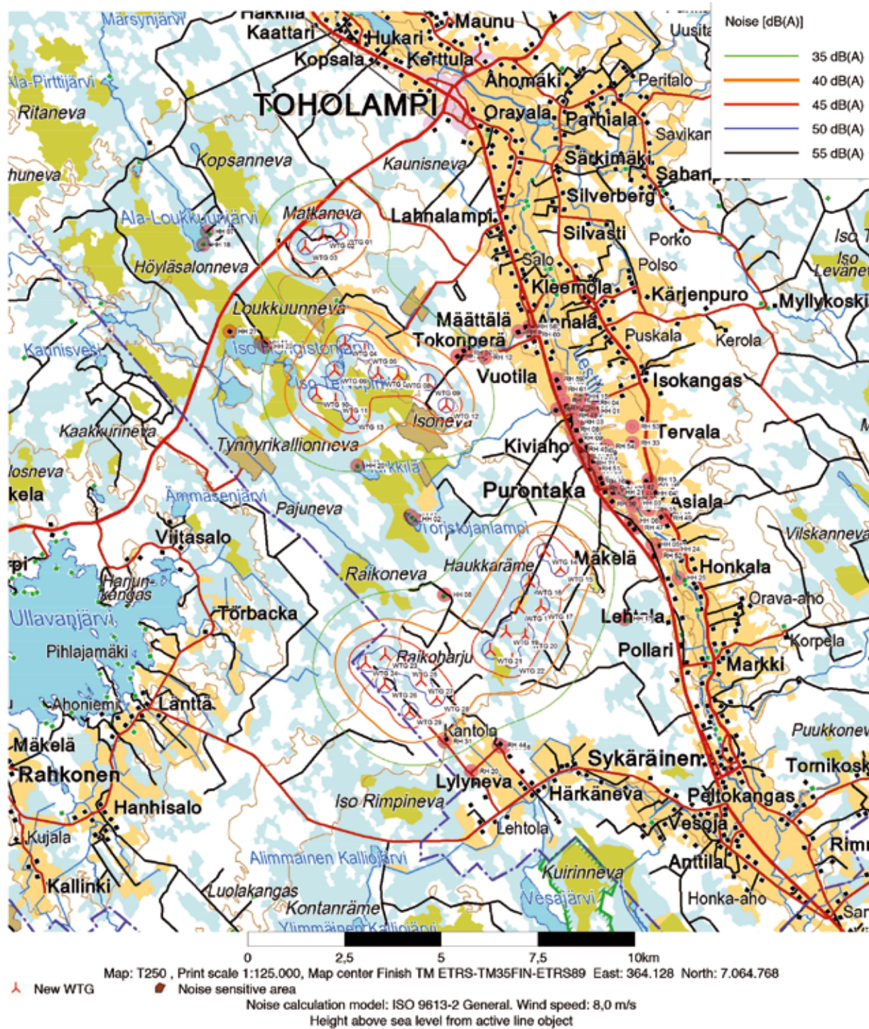
Kuva 105. Melumallinnuskuvaa VE2:stä (ISO 9613-2). Kuvassa HH-merkinnällä on osoitettu lähimmät loma-asunnot ja RH-merkinnällä lähimmät vakinaiset asunnot. HH08 on merkitty virbeellisesti loma-asunnoksi, vaikka se on virallisesti muu rakennus.
