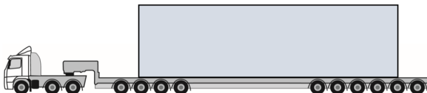
Kuva 3: Tyypillisen tornilohkokuljetuksen havainnekuva (ei mittakaavassa).
