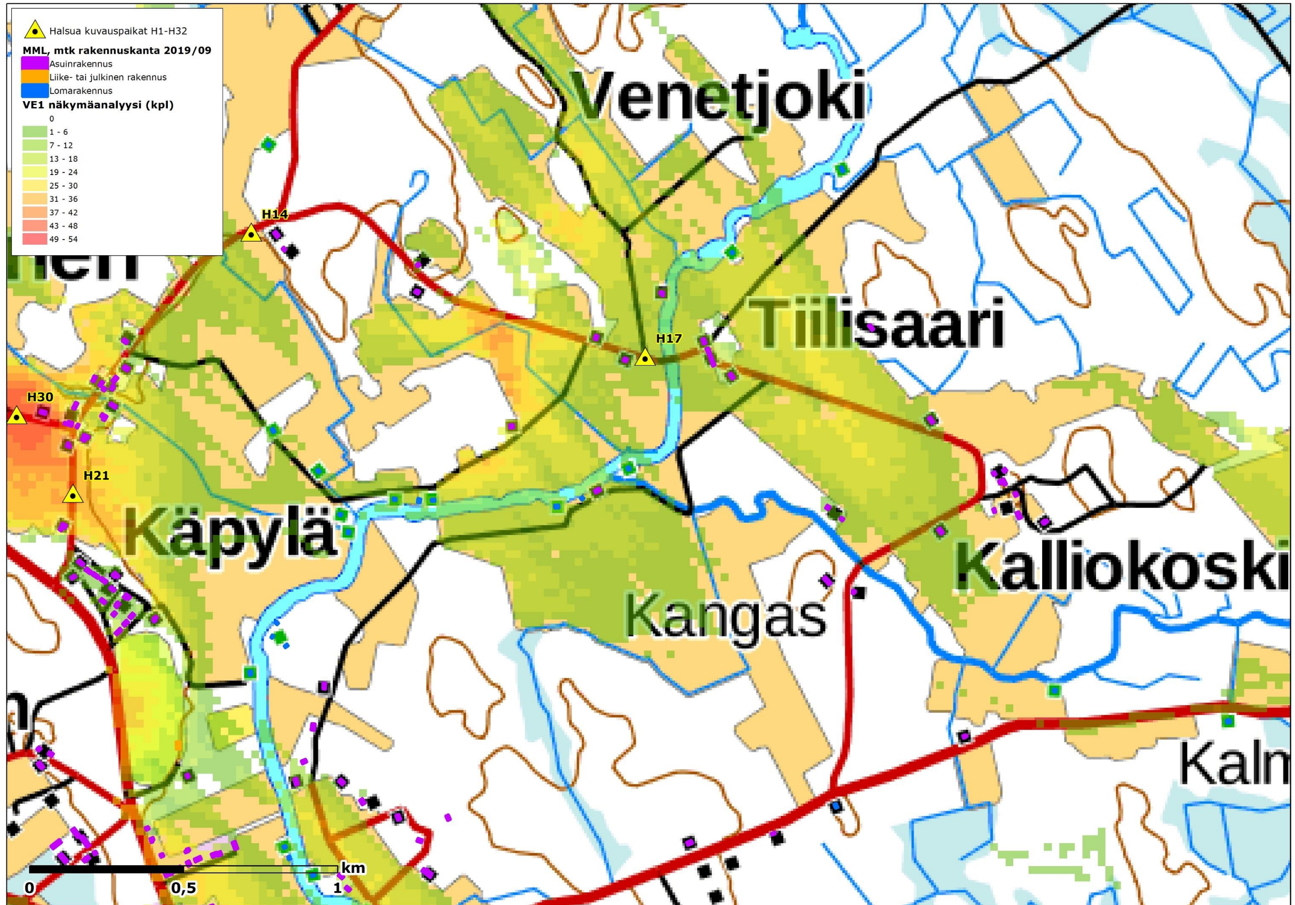
Kuva 25. Näkymäalueanalyysitulokset ja valokuvasoitteipaikka H17 Venetjoen Tiilisaarella Kalliokoskentie 253 kohdalla vaihtoehto 1 (VE1). Mallinnustuloksen mukaan voimaloita näkyisi 1 - 6 kpl.
