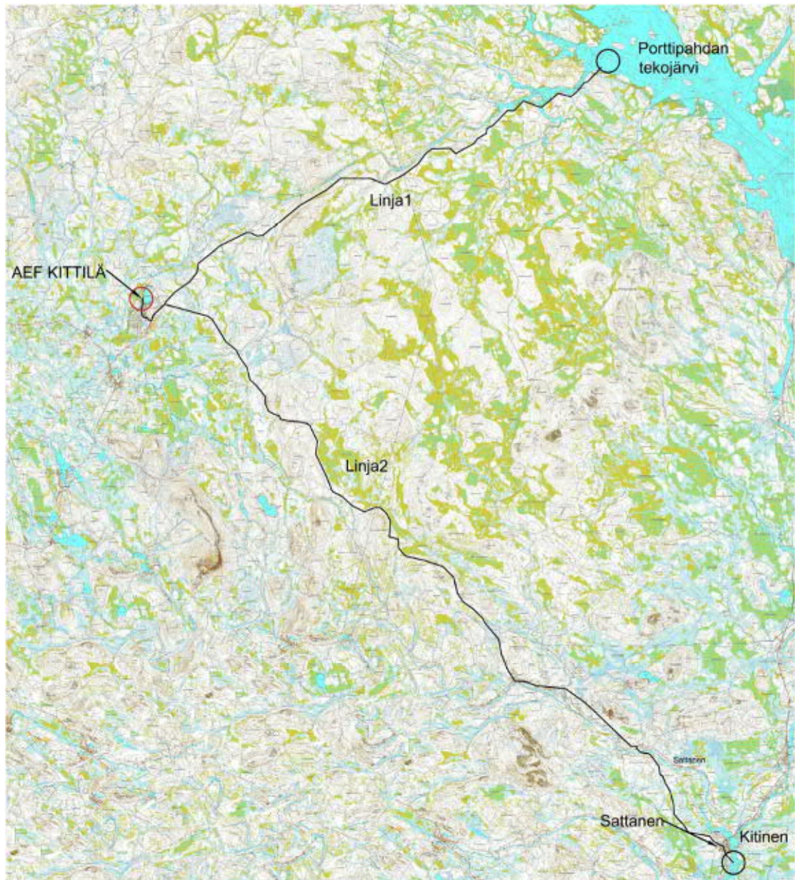
Kuva 5-5. Suunnitellut purkuputkinjaukset Porttipahdan tekojärveen (Linja 1) sekä Kitisen pääuomaan (Linja 2).
