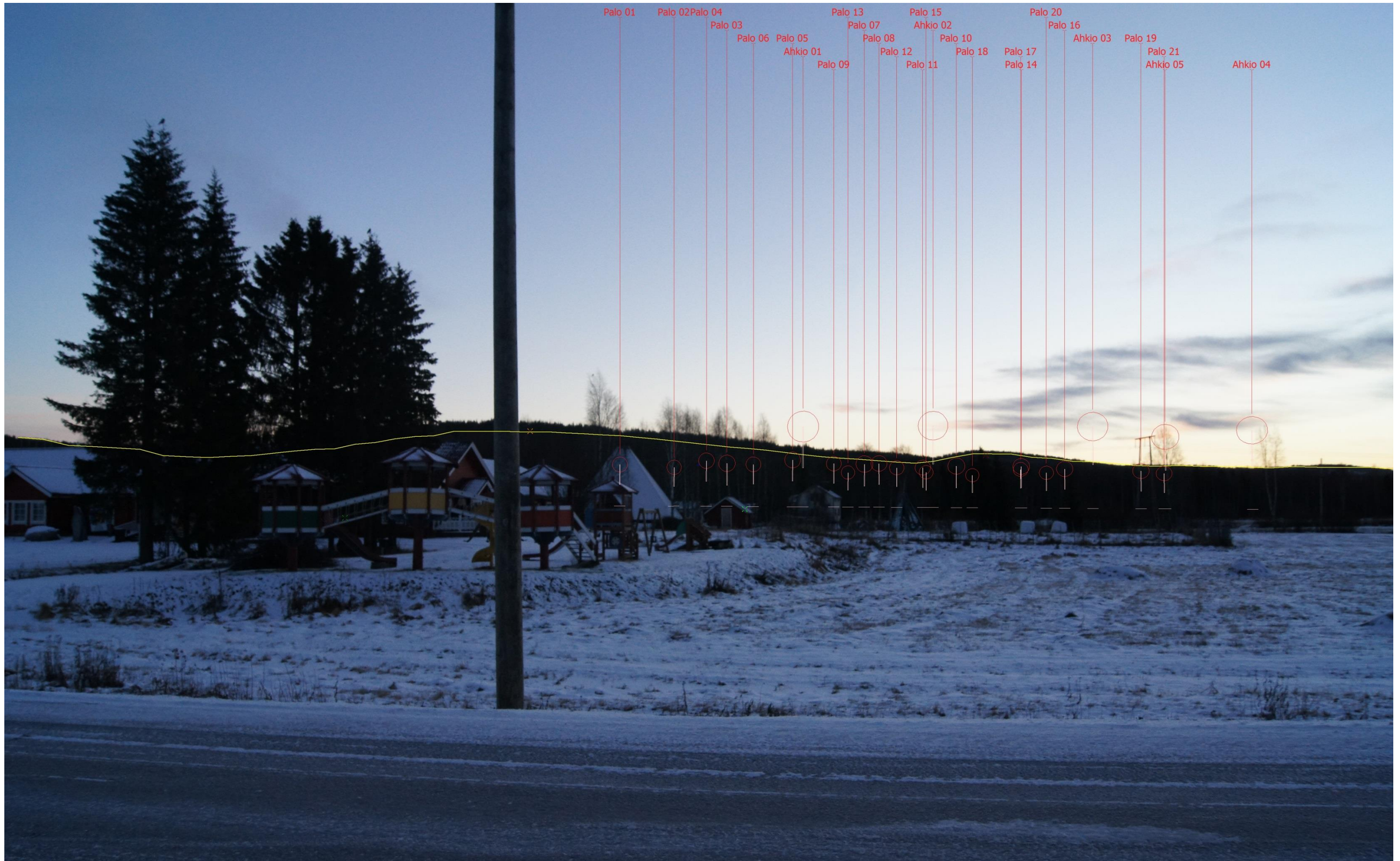
Kuvauspiste 1. VE2. Näkymä Torniontieltä, etäisyys lähimpään voimalaan noin 4,2 km. Kaaviokuva, jossa on esitetty voimalat maiseman edessä. Roottoriympyrä on korostettu punaisella, voimalatorni valkoisella ja maaston pinta keltaisella viivalla. Voimaloiden kokonaiskorkeus on 230 metriä, kameran objektiivi 18 mm. Ahkiovaaran voimalat näkyvät tielle, Palovaaran voimalat jäävät vaarojen taakse katveeseen.
