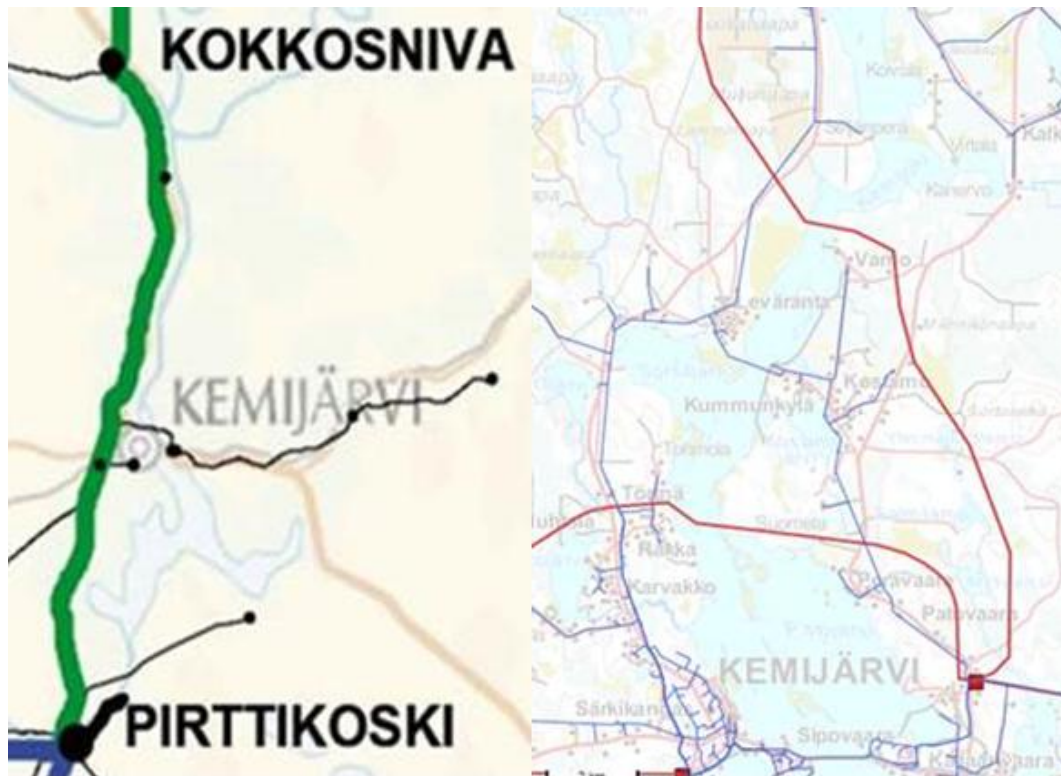
Kuva 2-13. Fingridin johto Pirttikosken ja Kokkosnivan välillä (vasemmanpuoleinen kuva) ja Koillis-Lapin Sähkö Oy:n nykyiset 110 kV voimajohdot (oikeanpuoleinen kuva).
