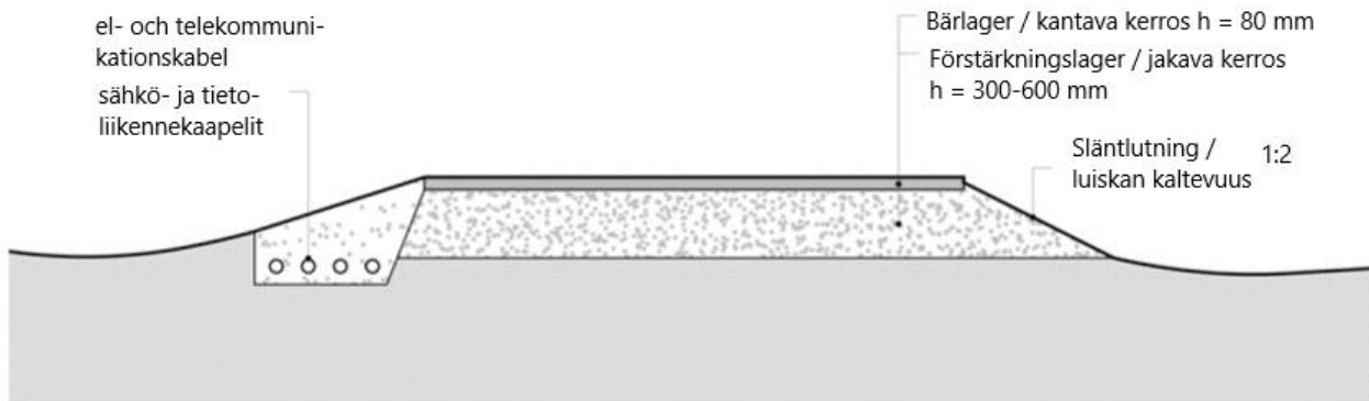
Konceptuell bild av konstruktionen på en ny och grundförbättrad väg.
