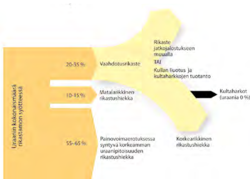
Kuva 7-7. Uraanin jakautuminen eri rikastushiekkajakeisiin koerikastuksen perusteella (prosentteina malmin sisältämästä uranimäärästä).
