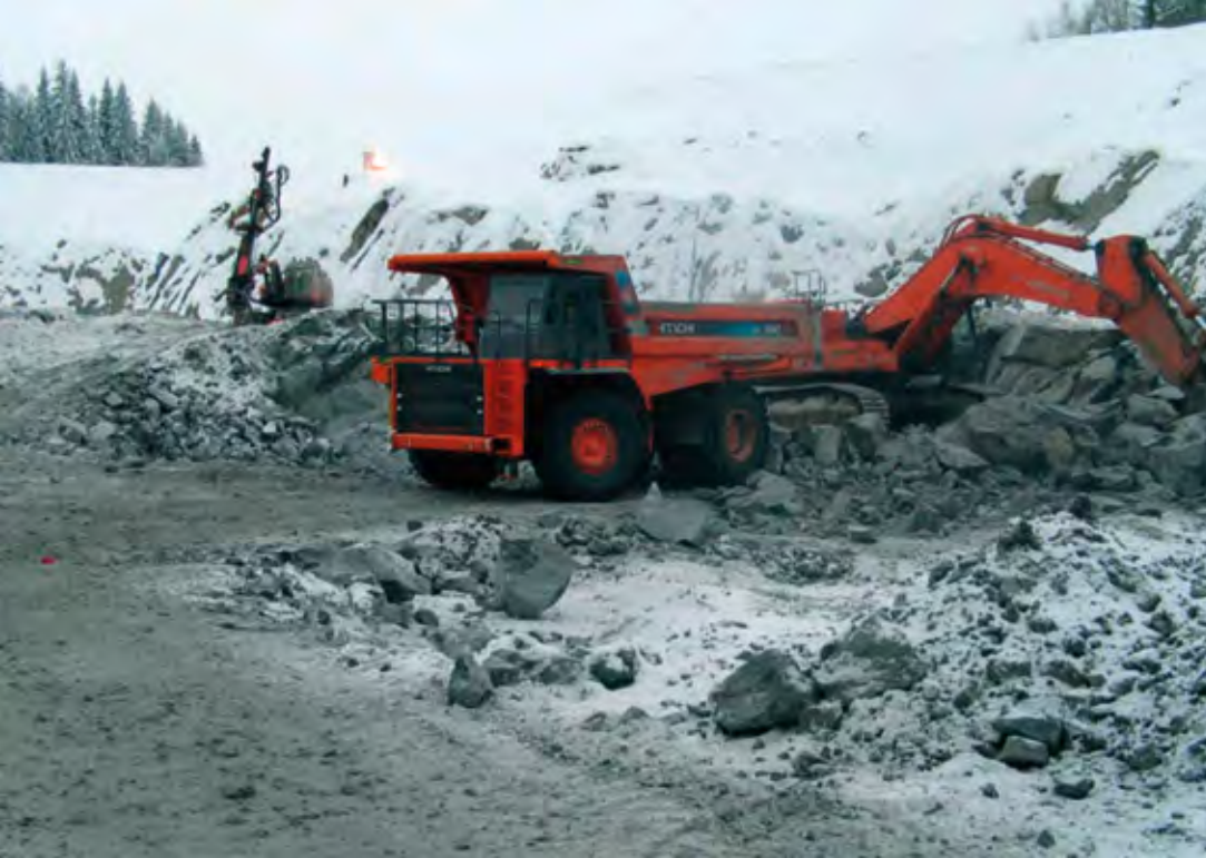
Kuva 7-3. Kalliosta louhitun malmin lastausta avolouhoksella Jokisivun kaivoksella Huittisissa (Dragon Mining Oy).
