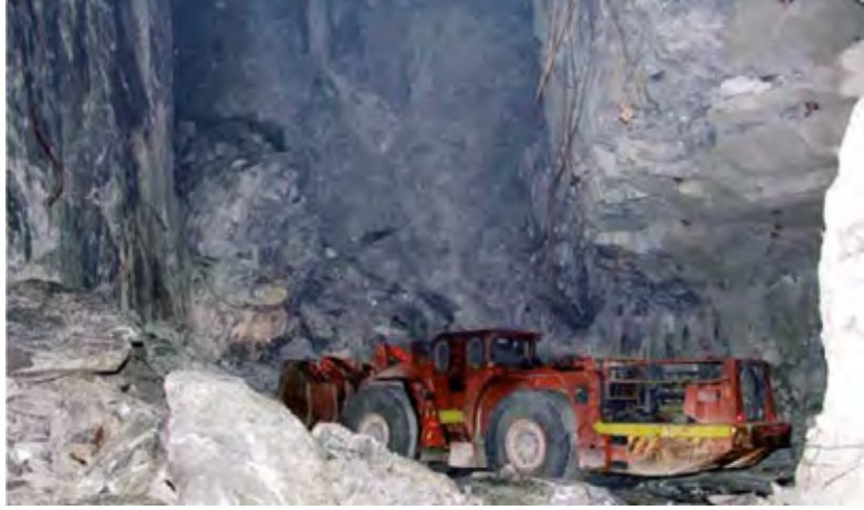
Kuva 7-10. LHD-laite maanalaisessa lastauksessa.
