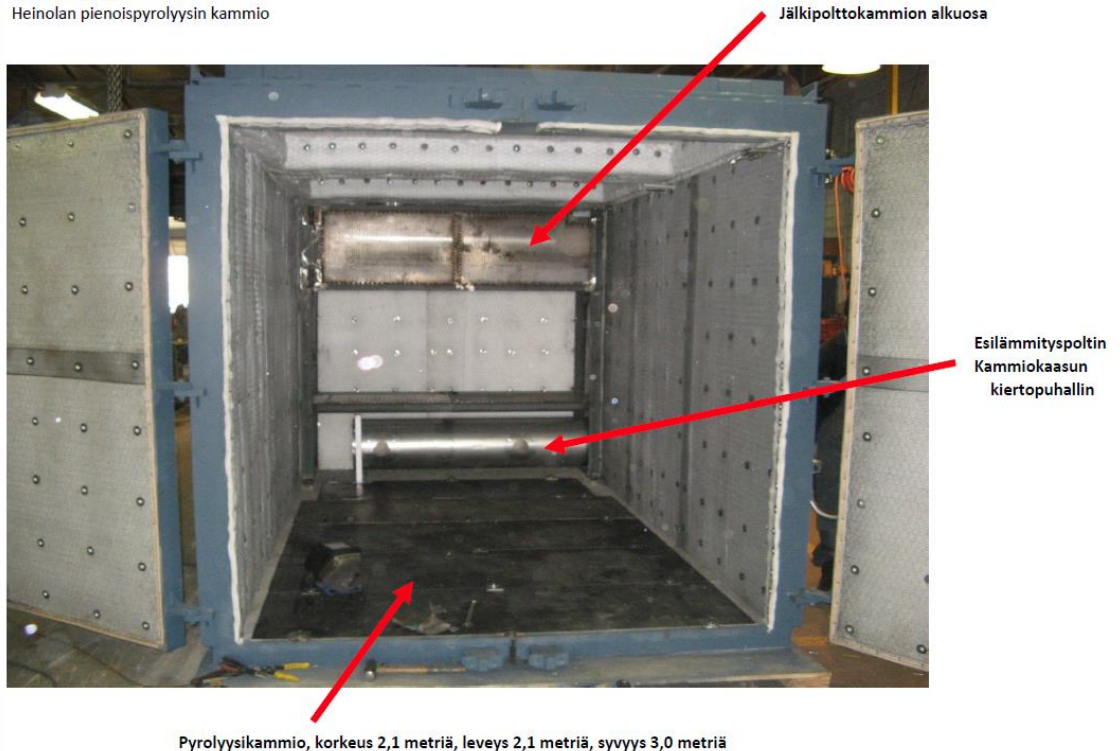
Kuva 2. Pyrolyysikammio.
