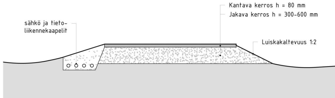
Periaatekuva uuden ja perusparannettavan tien rakenteesta.
