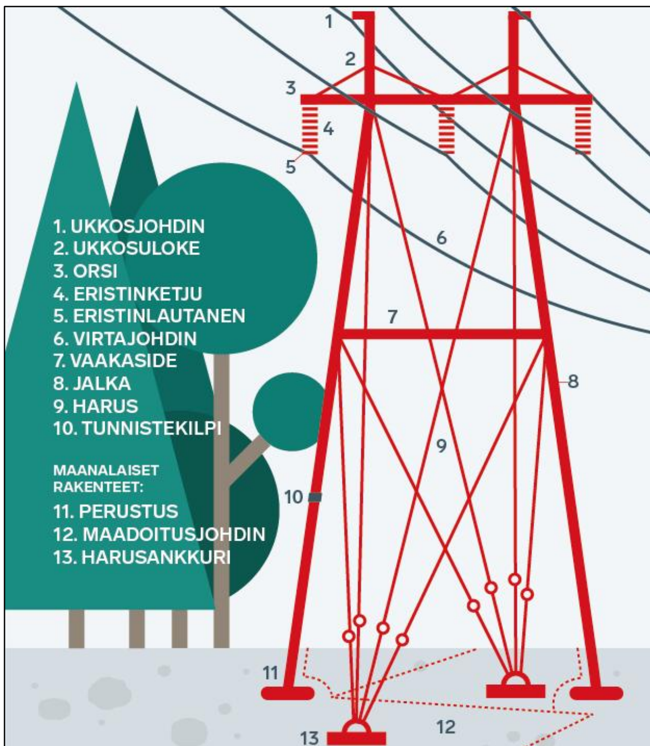
Kuva 22. Voimajohdon osat (Fingrid 2020).
