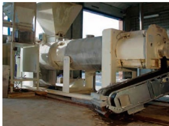
Kuva 4-12 Lietteen kalkkistabilointilaitteet (kuva: European Lime Association)
