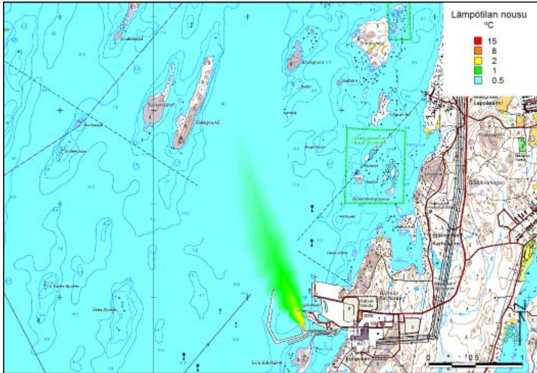
Kuva 33. Nykyisen hiilikattilan kesäaikainen jäähdytysveden lämpövaikutusalue suurimmillaan, kun jäähdytysvedet puretaan satama-alueelle.
