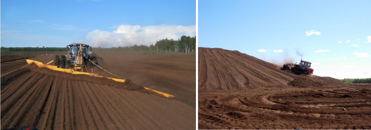
Kuva 4-3 Turvetuotannon työvaiheita. Yllä oikealla mekaaninen kokoojavaunu, yllä vasemmalla haku-menetelmä kääntäminen, alla vasemmalla haku-menetelmä karheaminen ja alla oikealla hakumenetelmä aumaus. (Kuvat Vapo Oy ja Turveteollisuusliitto ry)
