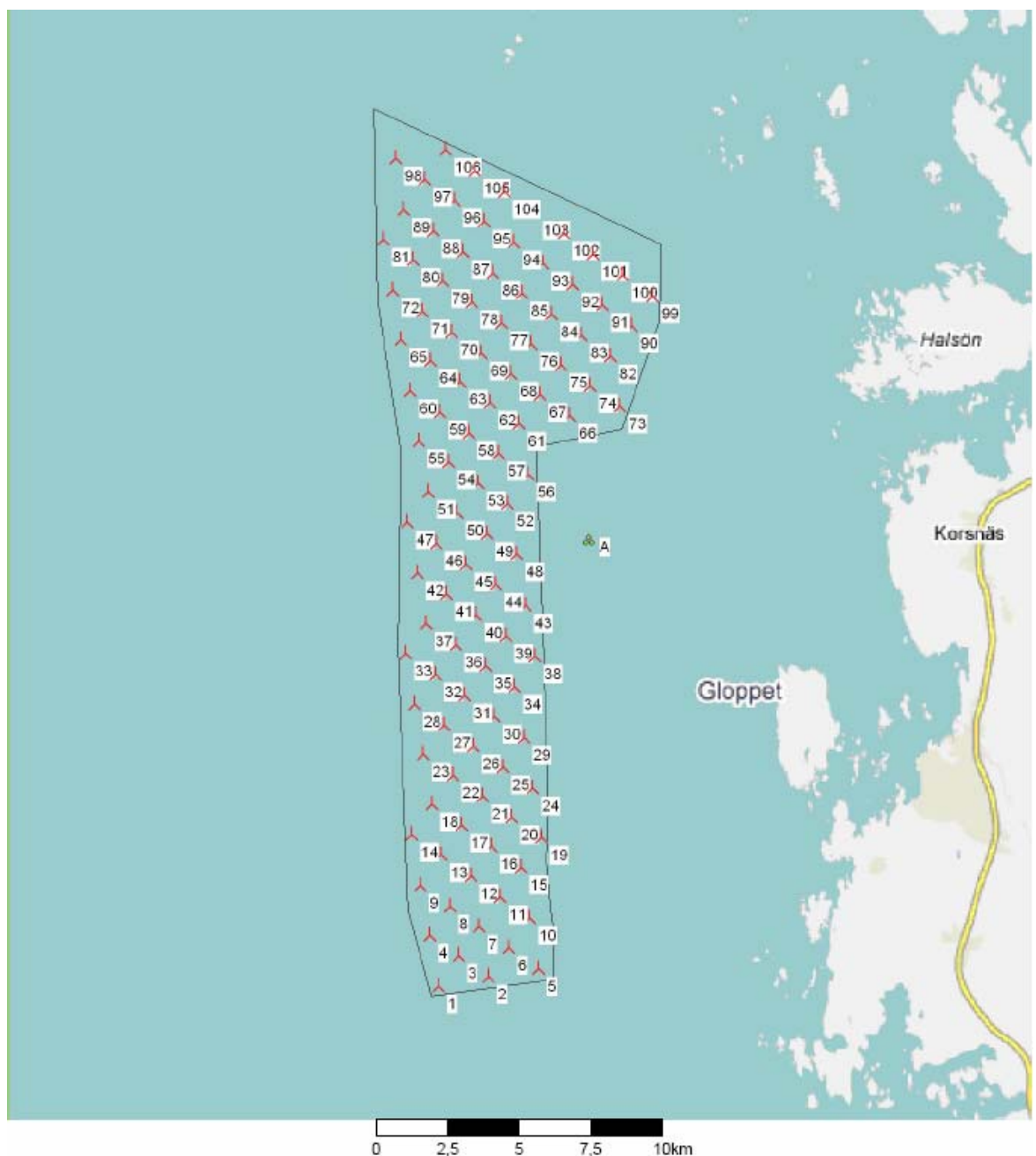
Kuva 4-1. Esimerkki Korsnäs merituulipuiston alustavasta asemapiirroksesta.
