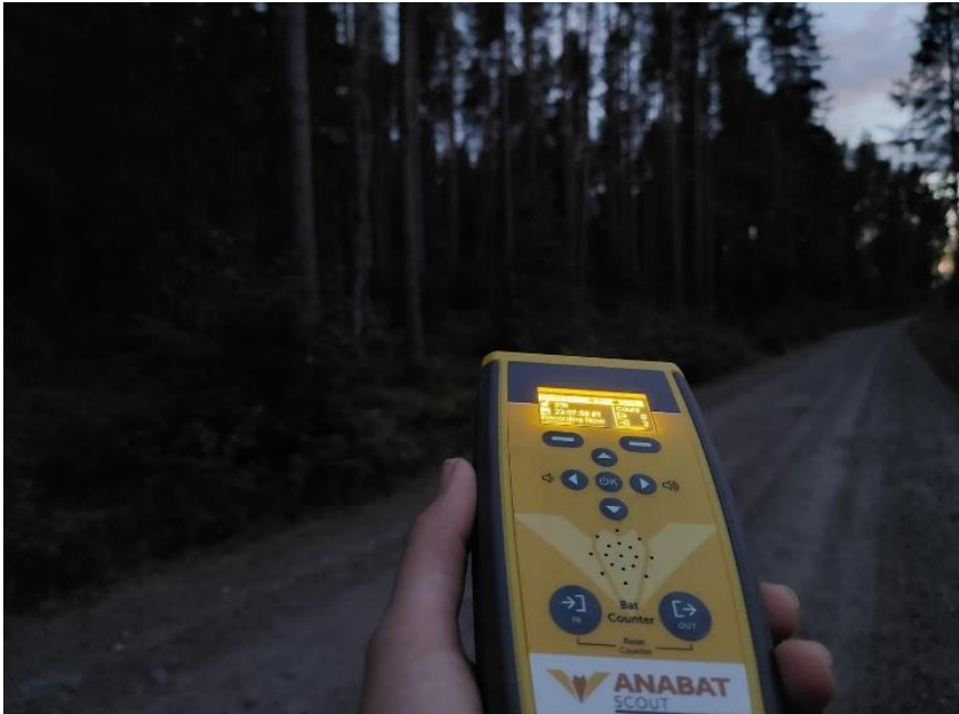
Kuva 4-1. Lepakkokartoituksessa käytetty Anabat scout -detektori havaitsee lepakkojen kaikuluotausääniä muuttaen ne ihmiskorvin kuultavaksi. Detektori kertoo automaattisesti havaitun äänen korkeuden kilohertseinä, minkä avulla voidaan tehdä lajimääritys.
