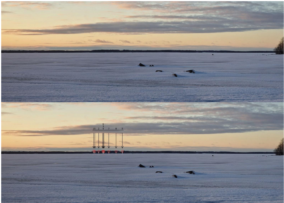
Kuva 17-14. VE1 tuulivoimalat Joensuun Kuhasalosta kuvattuna idän suuntaan (kuvauspiste 8). Etäisyys lähimpiin voimaloihin on noin 33,5 km. Havainnollisuuden vuoksi voimalat on esitetty alemmassa kuvassa ns. rautalankamallina.
