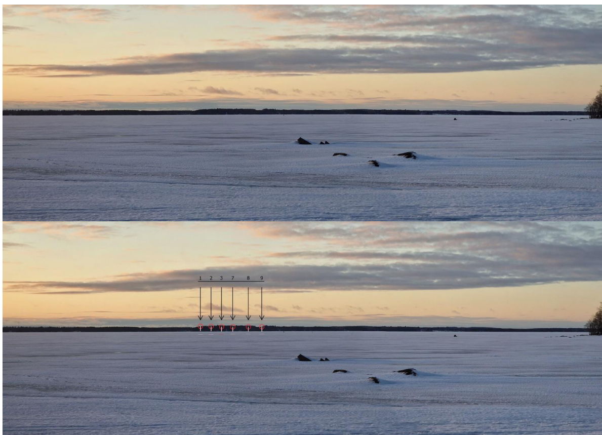
Kuva 17-23. VE2 tuulivoimalat Joensuun Kuhasalosta kuvattuna idän suuntaan (kuvauspiste 8). Etäisyys lähimpiin voimaloihin on noin 33,5 km. Havainnollisuuden vuoksi voimalat on esitetty alemmassa kuvassa ns. rautalankamallina.
