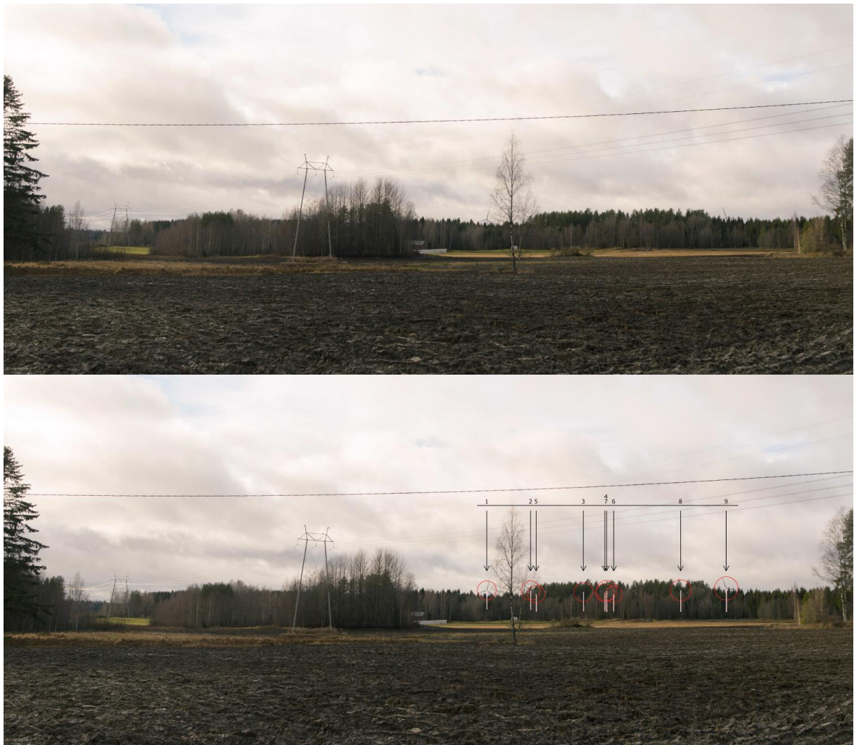
Kuva 17-13. VE1 tuulivoimalat Liettilän peltoalueelta (kuvauspiste 5). Etäisyys lähimpiin voimaloihin on noin 6,7 km. Havainnollisuuden vuoksi voimalat on esitetty alemmassa kuvassa ns. rautalankamallina.
