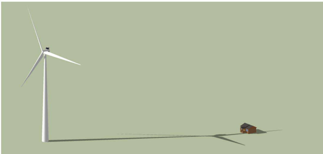
Kuva 4-23. Varjon vilkunta muodostuu, kun tuulivoimala pyörii tarkastelupisteen ja auringon välissä, aurinkoisella ja pilvettömällä säällä.
