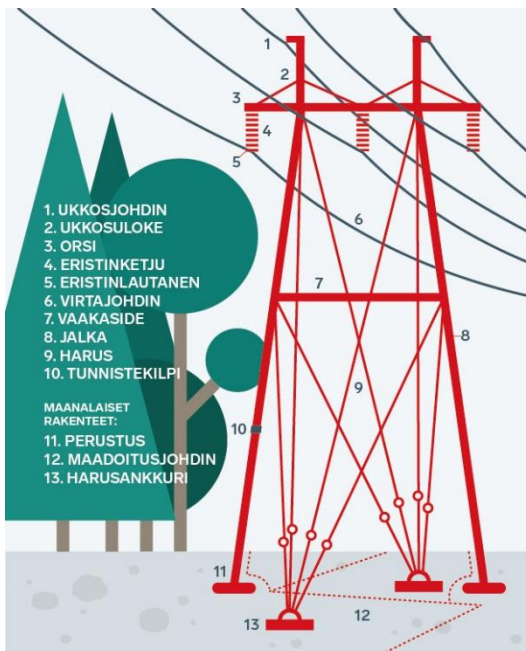
Kuva 4-2. Voimajohdon osat (Fingrid 2020).
