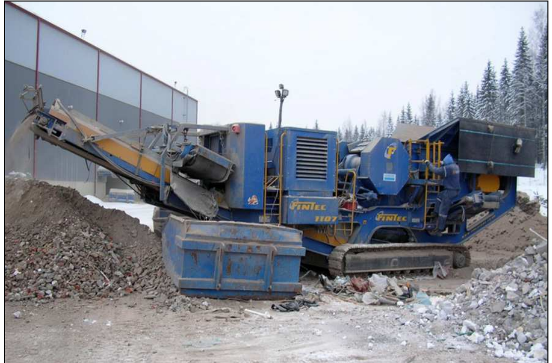
Kuva 6. Toisen vaiheen siirrettävä leukamurskain Fintec 1107 6 .
