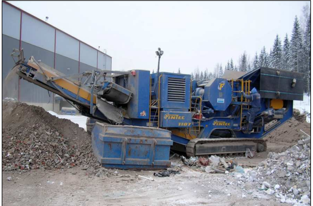
Kuva 6. Toisen vaiheen siirrettävä leukamurskain Fintec 1107 6 .
