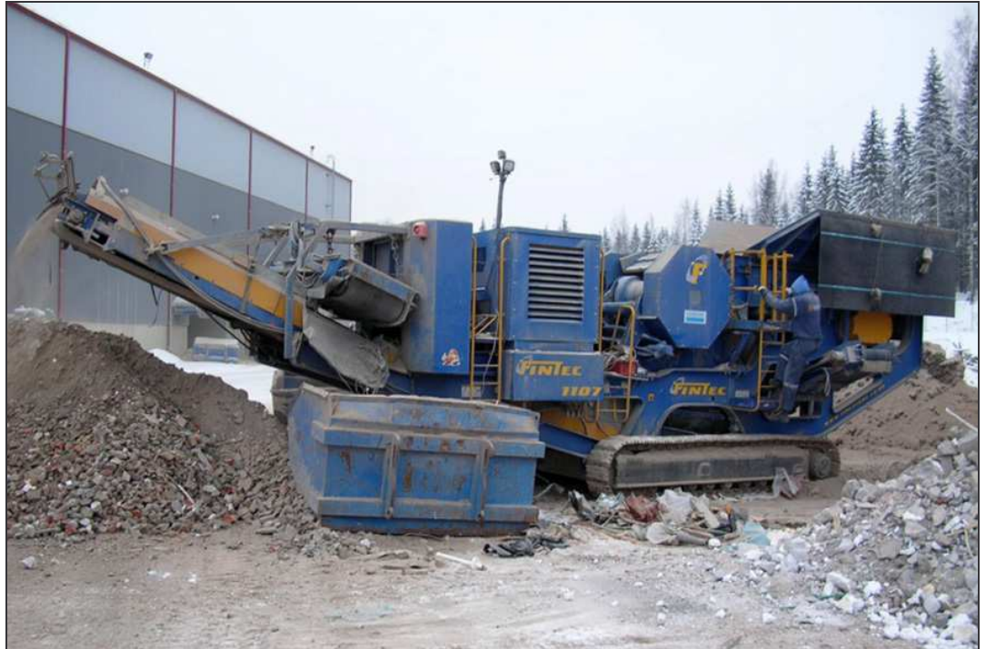
Kuva 7. Toisen vaiheen siirrettävä leukamurskain Fintec 1107 5 .
