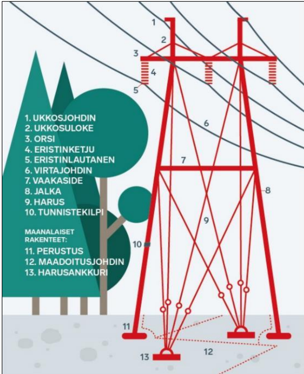
Kuva 9. Voimajohdon osat (Lähde: Fingrid 2020).
