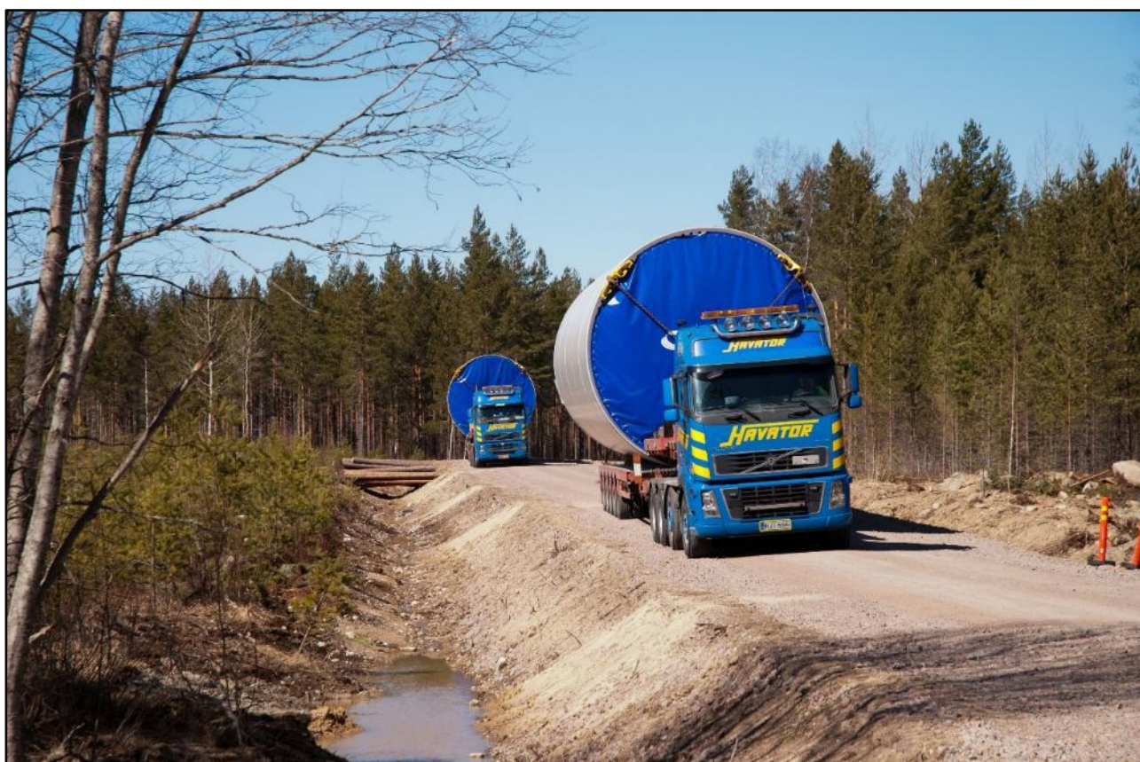
Kuva 37. Esimerkkikuva tuulivoimalan tornin osien kuljetuksesta hankealueella ja valmiista huoltotiestä (Taaleri Energia Oy).
