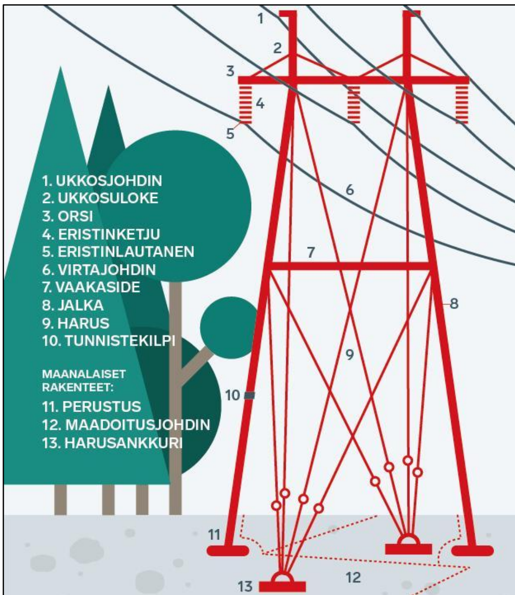
Kuva 35. Voimajohdon osat (Lähde: Fingrid 2020).
