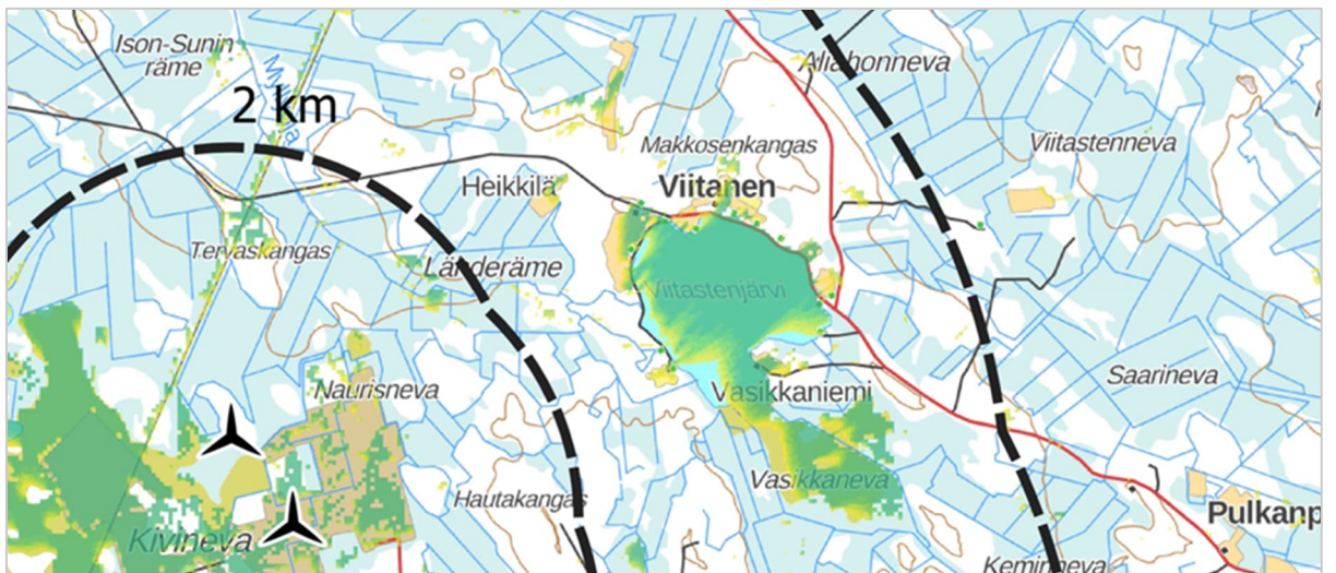
Kuva 61. VE3 näkyvyys näkyvyysalueanalyysin perusteella Viitastenci järven alueella. Pääasiassa kaikki voimalat (9 tuulivoimalaa) näkyvät järven selältä, pohjois- ja itärannoilta sekä asutuksesta. Etäisyysvyöhykkeet 2 km ja 5 km. (Etha Oy)
