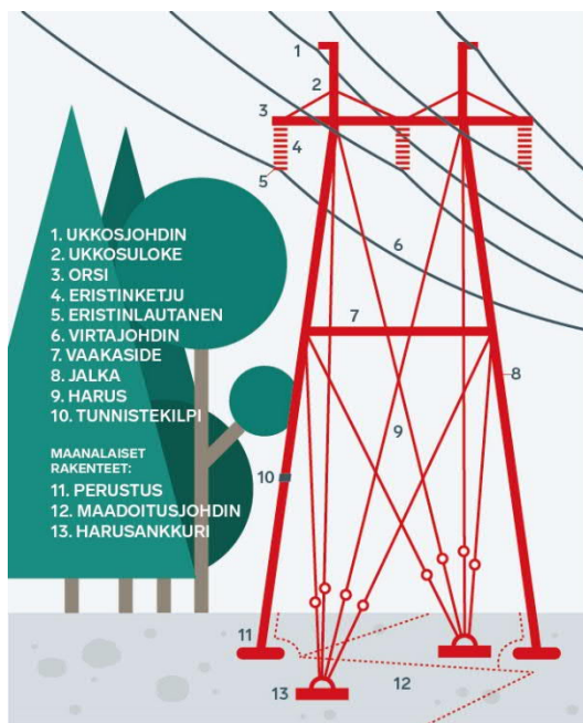
Kuva 3-3. Voimajohdon osat (Fingrid 2020).
