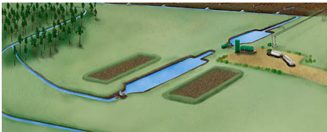
Kuva 13. Kemiaallinen puhdistus vesienkäsittelymenetelmänä (Turveteollisuusliitto 2009:13)
