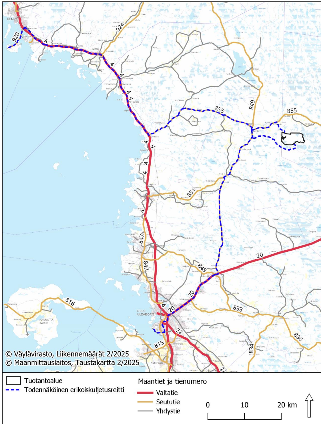
Kuva 16-2 Tuulivoimaloiden osien todennäköisin kuljetusreitti Oulun satamasta ja vaihtoehtoinen kuljetusreitti Kemin Ajoksen satamasta tuotantoalueelle.
