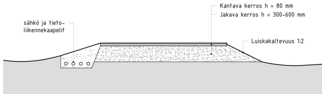
Periaatekuva uuden ja perusparannettavan tien rakenteesta.
