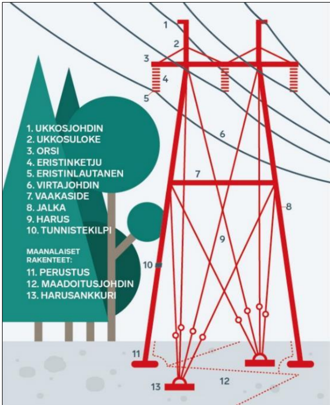
Kuva 8. Voimajohdon osat (Lähde: Fingrid 2020).
