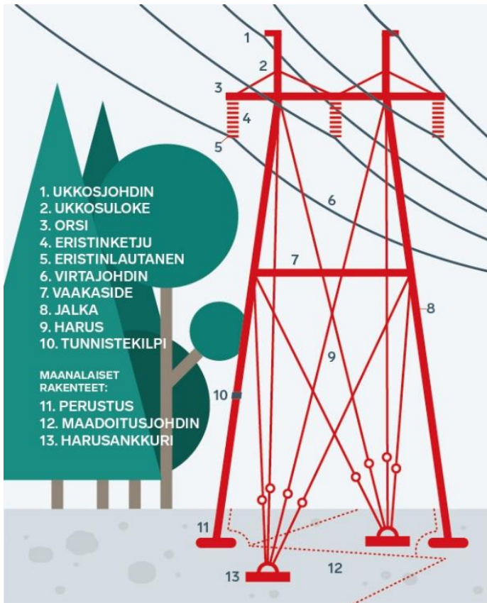
Kuva 3-3. Voimajohdon osat (Fingrid 2020).
