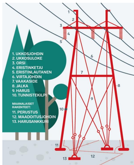
Kuva 4-1. Voimajohdon osat (Fingrid 2020).
