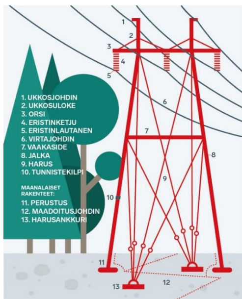
Kuva 2-1. Voimajohdon osat. (Fingrid 2020)
